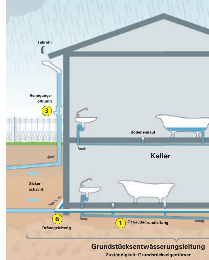
Ein ausgeklügeltes System sorgt dafür, dass das Abwasser nicht auf dem Grundstück verbleibt, sondern durch den Schmutzwasserkanal zur Kläranlage fließt. Das Regenwasser versickert vor Ort.
